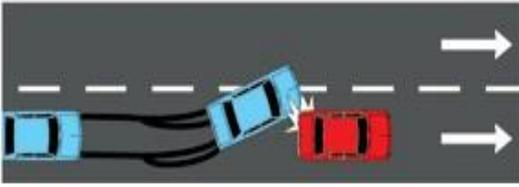
**잠김 방지 브레이크 시스템 (Anti-Lock Braking System)이 없는 비상상황이나 미끄러운 상황에서는 모든 바퀴가 잠기며 차는 미끄러져 조종할 수 없습니다.**
