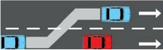
**잠김 방지 브레이크 시스템 (Anti-Lock Braking System)이 적용된 비상 상황이나 미끄러운 상황에서는 바퀴가 잠기지 않습니다. 자동차는 안정적이고 조종 가능한 상태를 유지합니다.**
